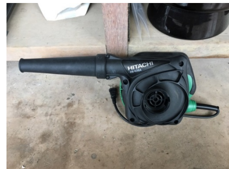
写真-3 ブロワ(送排風機)
