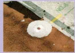
量産タイプの路面埋込積雪センサー
