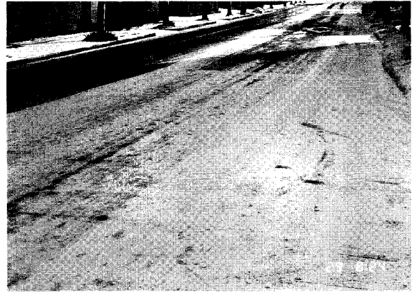
8 : 24 (30分経過) 散布ポイントから165m地点まで引きずり効果を確認。 (90m地点まではわだち部において完全に路面露出。一方、散布地点以前の区間ではまだ圧雪が残り凍結状態だった。)
