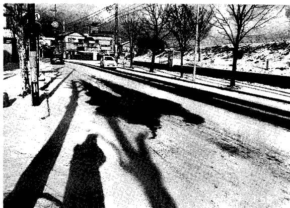
7:58（4分経過） 散布ポイントにて路面露出が始まる
