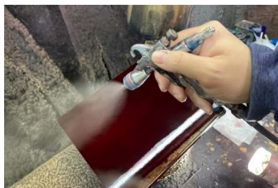
漆塗りの吹付け作業工程
