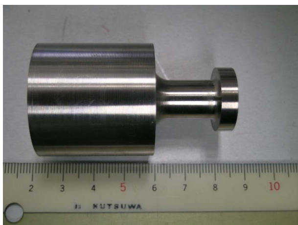
設計し試作した超音波ホーン
