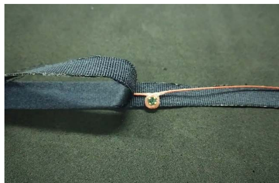
高周波対応導電糸を使用した RFID ファイバーのテキスタイル組み込み例
