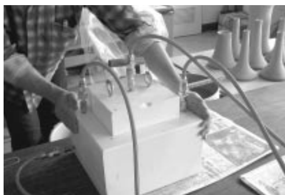
写真2 プレス用石膏型と通気機構
