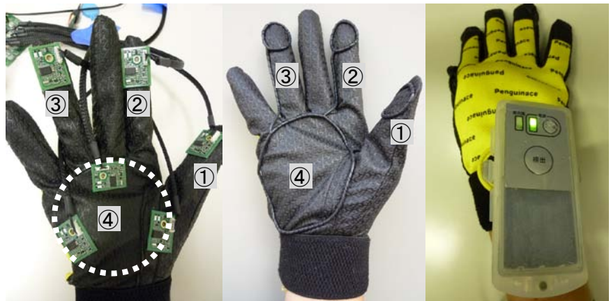
図2 実験での最適配置例と開発した手袋型RFIDリーダー (左) リーダーアンテナの最適配置 (中央)リーダー試作機(アンテナ部) (右) リーダー試作機(R/W部)
