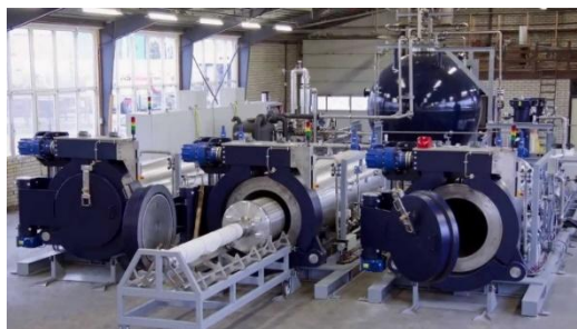
DyeCoo 社の超臨界流体染色機 (3 チューブで 1 セットとしているタイの Tong Siang 社では 2 セットが導入され 2009 年から稼動。台湾の 4 社にも導入済み)
