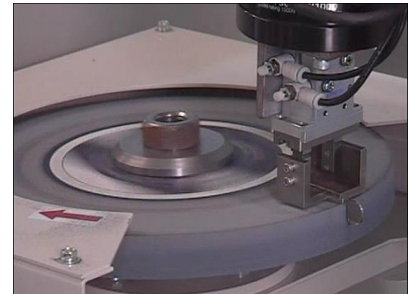
ロボットによる楽器部品の研磨作業
