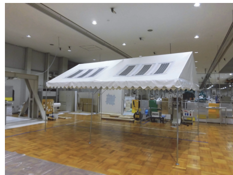
開発した太陽光発電テント (スフェアパーク(株) (京都市)、松文産業(株)、 ウラセ(株)、福井太陽(株)との共同開発)
